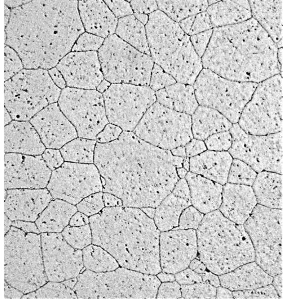
Compuestos precipitados (400X). Inaceptable
